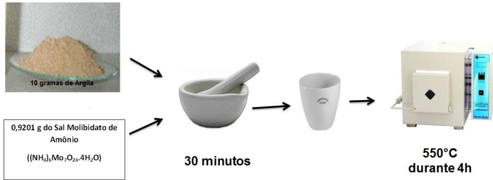
Figura 1: Ilustração do processo de impregnação de metais
