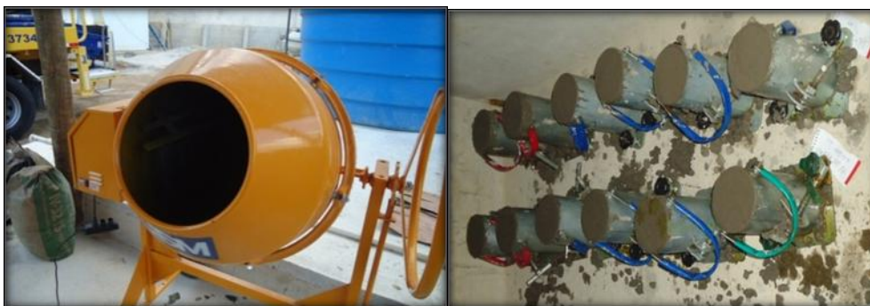
Figura 2: Betoneira simples utilizada e corpos-de-prova fabricados.
