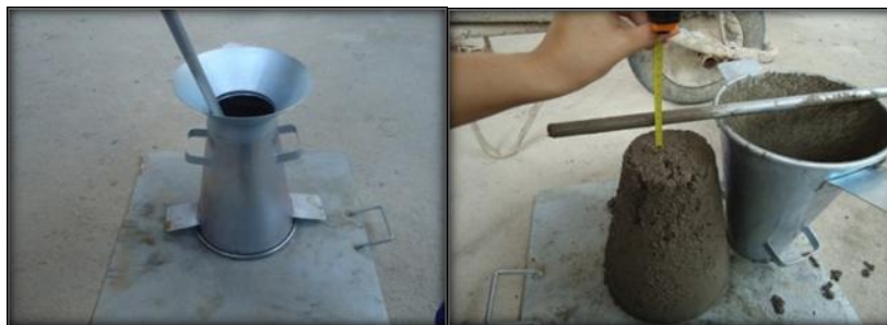
Figura 3: Slump test por meio do abatimento do tronco de cone.
