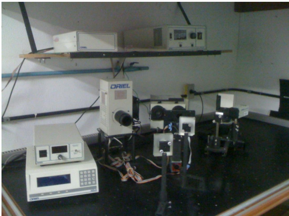
Figura 2 – Bancada experimental com o braço do goniômetro rotacionado, à direita.
