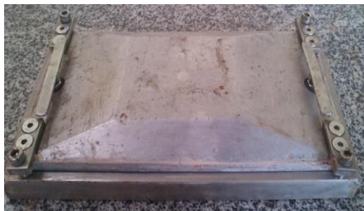
Figura 1. Molde metálico para produção das placas de compósitos.
