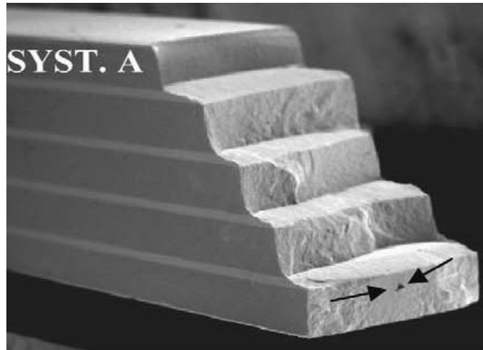
Figura 4: Fratura em degrau de compósito multicamada (14) .
