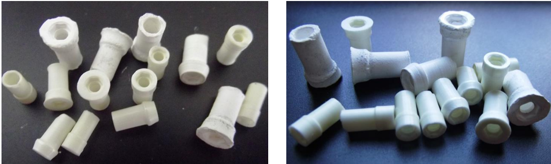
Figura 12 - Pilares cerâmicos produzidos a partir dos estudos realizados.
