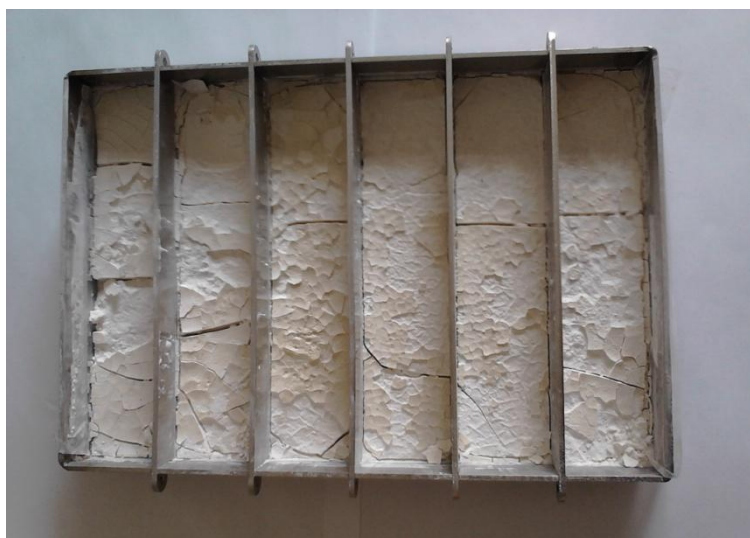
Figura 1: Peças de alumina no molde, logo após ser retirado da estufa.
