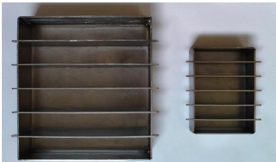
Figura 2: Comparação de tamanho do antigo molde (esquerda) com novo (direita).
