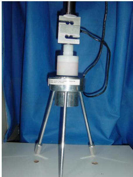
Figura 2. Sistema célula de carga, êmbolo e Copo Ford
