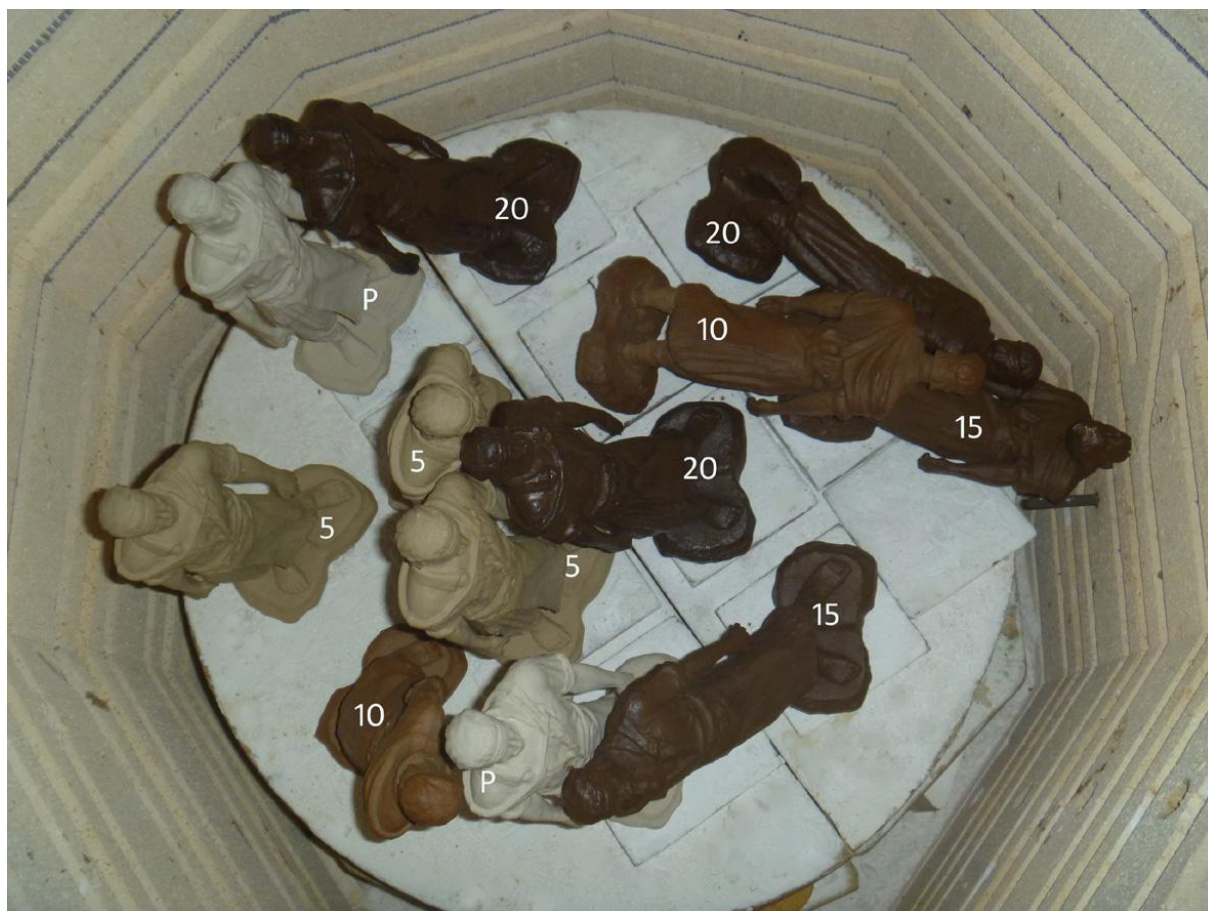
Figura 108. Abertura do forno após sinterização a 1220°C: (P) peças fundidas com a porcelana Biscuit Volpetiz; peças fundidas com barbotinas incorporadas com (5) 5% em peso; (10) 10% em peso; (15) 15% em peso; (20) 20% em peso do resíduo pó de aciaria.
