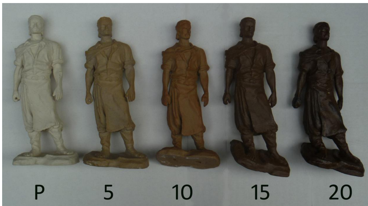
Figura 119. Exemplos das diferentes barbotinas após sinterização a 1220°C: (P) porcelana Biscuit Volpetiz e barbotina incorporada com (5) 5% em peso; (10) 10% em peso; (15) 15% em peso; (20) 20% em peso do resíduo pó de aciaria.
