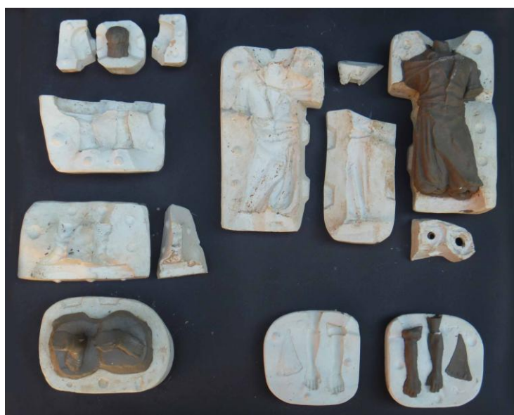
Figura 2. Primeira fundição e os 14 taceiros que compõem o molde de gesso da estatueta.
