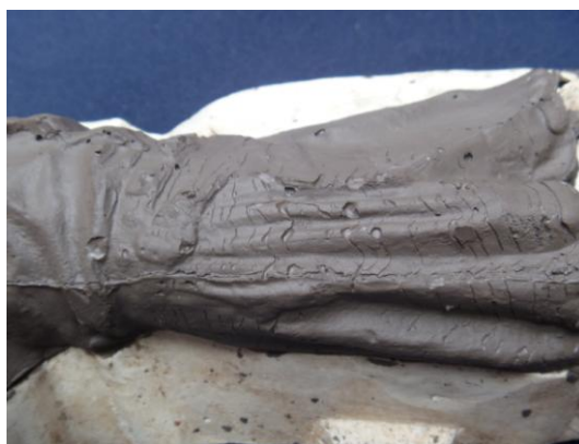
Figura 86. Defeitos em peça fundida com incorporação de 20% em peso de pó de aciaria.
