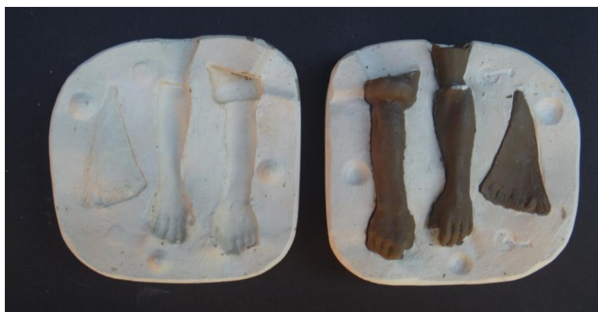
Figura 43. Abertura dos tacelos referentes aos antebraços e à ponta do tirador da estatueta O Laçador
