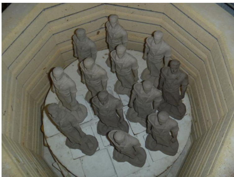
Figura 97. Estatuetas O Laçador a verde dentro do forno elétrico.
