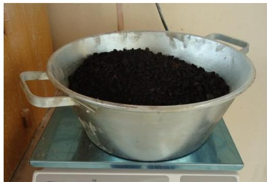
Fig. 2) Lodo após processo de queima.
