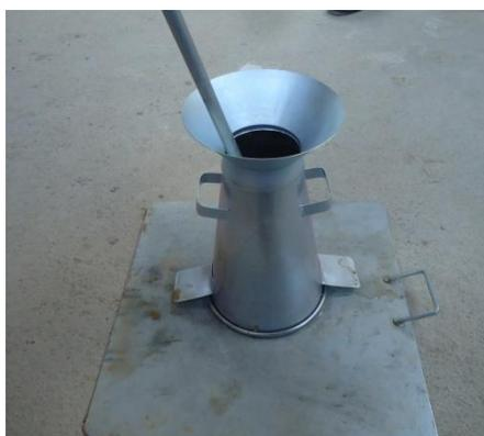
Fig. 4) Cone metálico utilizado no *slump test*.
