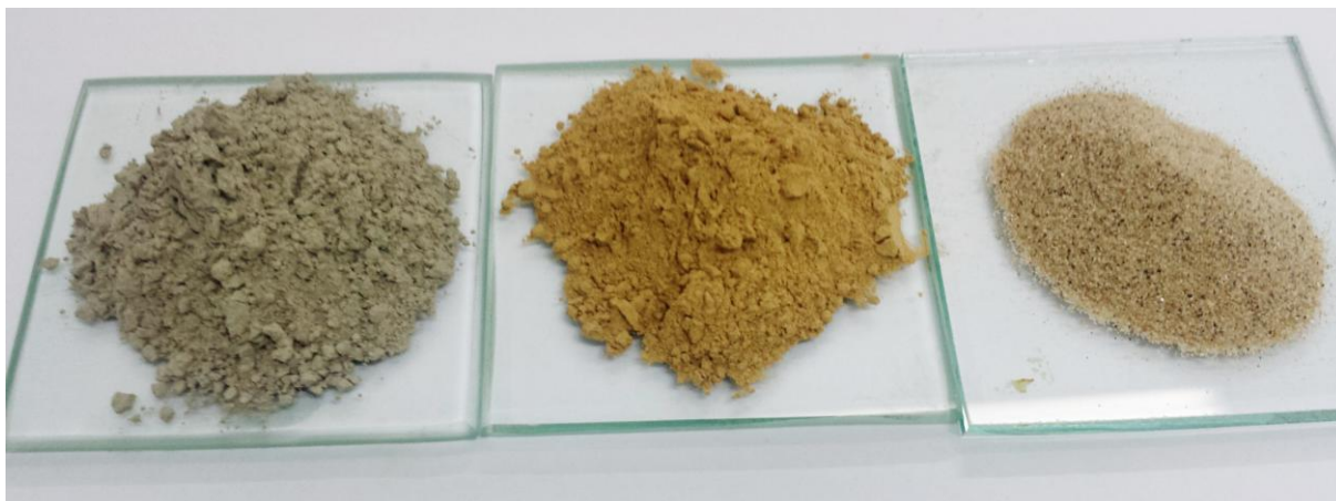
Figura 1. Aglomerantes utilizados para a preparação dos corpos de prova: Cimento Portland Tipo II, Argila Bentonítica e Resíduo Sintético de Mercúrio
