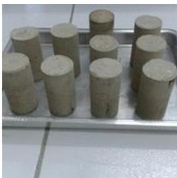
Fig.2: Corpos de prova submetidos ao tempo de cura
