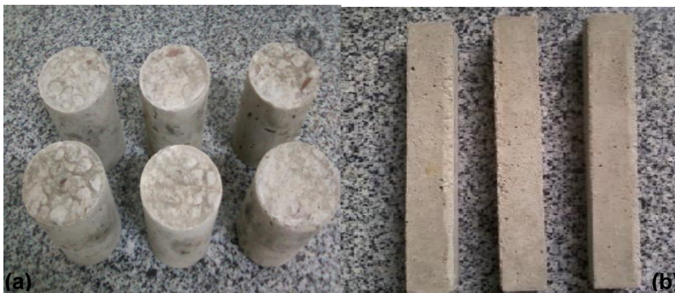
Figura 1: (a) Blocos de concreto cilíndricos com agregados sintéticos; (b) Blocos de concreto prismáticos com agregados sintéticos.
