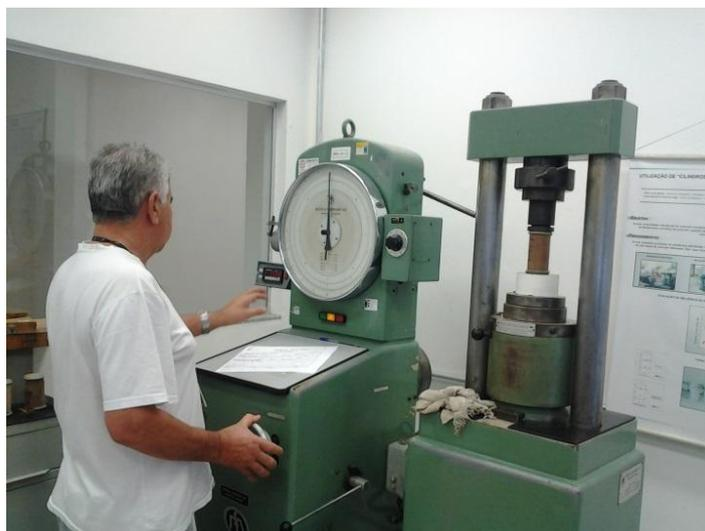
**Figura 3** – Ruptura de corpo de prova para determinação de índice de atividade pozolânica com a cal.
