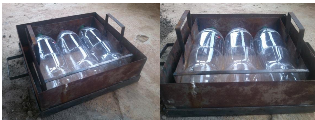
Figura 02: Fôrma de metal com garrafas PET utilizados para confecção de blocos de concreto.
