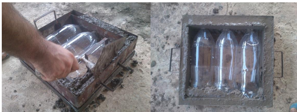
Figura 03: Processo de confecção dos blocos com fôrma de metal.
