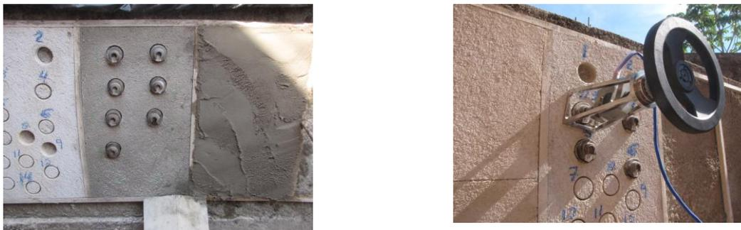
Figura 1 – a) Execução do painel de argamassa para revestimento de paredes;
