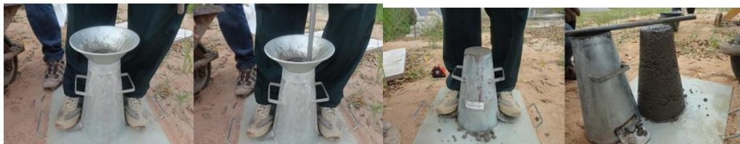
FIGURA 1 - Slump test do concreto padrão.
