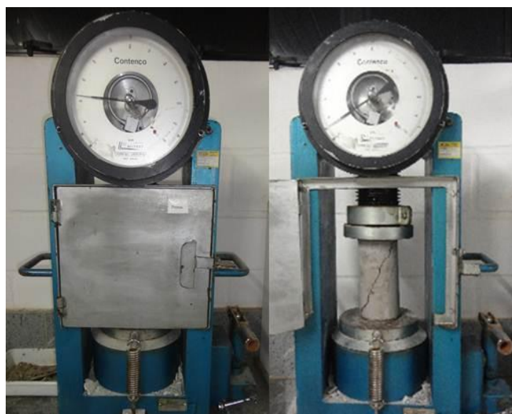
FIGURA 5 - Rompimento do corpo de prova.
