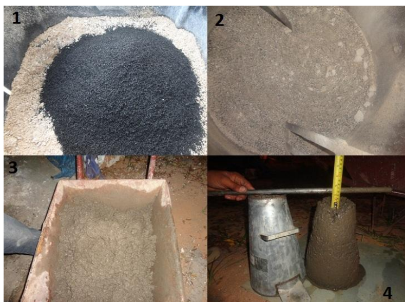
FIGURA 2 - 1: Borracha sendo colocada com o agregado miúdo na balança; 2: Mistura da borracha com o agregado miúdo na betoneira; 3: Aspecto do concreto pronto; 4: Slump test.
