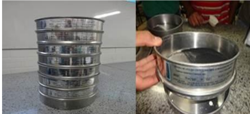
FIGURA 2 - Peneiras e ensaio de granulometria.
