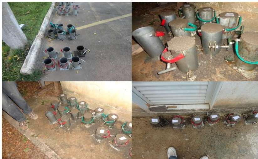
FIGURA 6 - Fôrmas antes e depois da moldagem dos corpos de prova.
