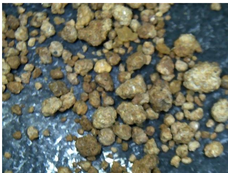
Figura 2: Morfologia dos grânulos da massa cerâmica TR2.
