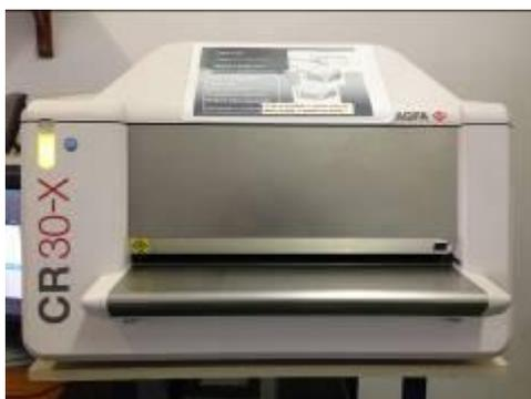
**Figura 4:** Aparelho de radiografia computadorizada CR 30-X AGFA.
