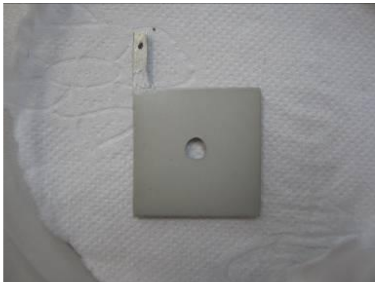
Figura 5 – Revestimento cerâmico obtido por plasma eletrolítico.
