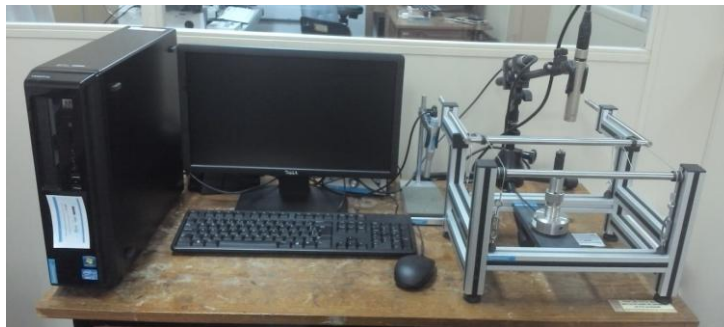
Fig.4 – Aparelho utilizado na realização da técnica através do software Sonelastic.
