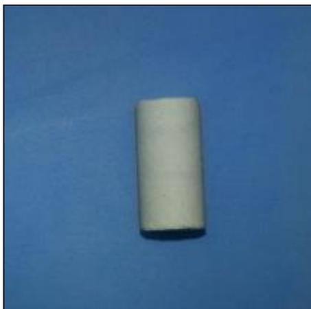
Figura 1. Corpo de prova à base de cimento  $\alpha$ -TCP e sulfato de gentamicina
