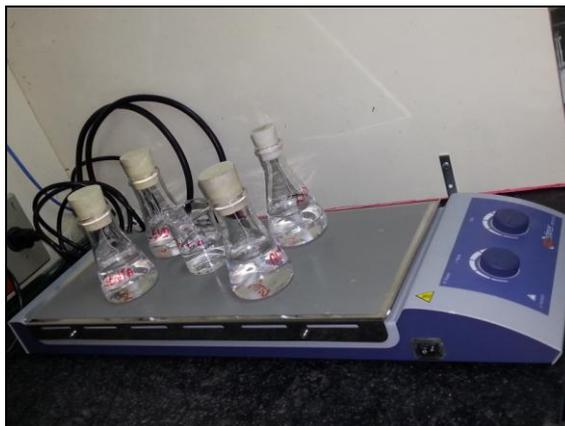
Figura 2. Corpos de prova imersos em solução – início dos testes *in vitro*.
