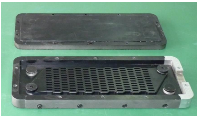
Figura 2 – Vista do molde usado na construção das placas aletadas. As aletas possuem um ângulo de saída de 5° e as superfícies escuras estão recobertas com teflon.
