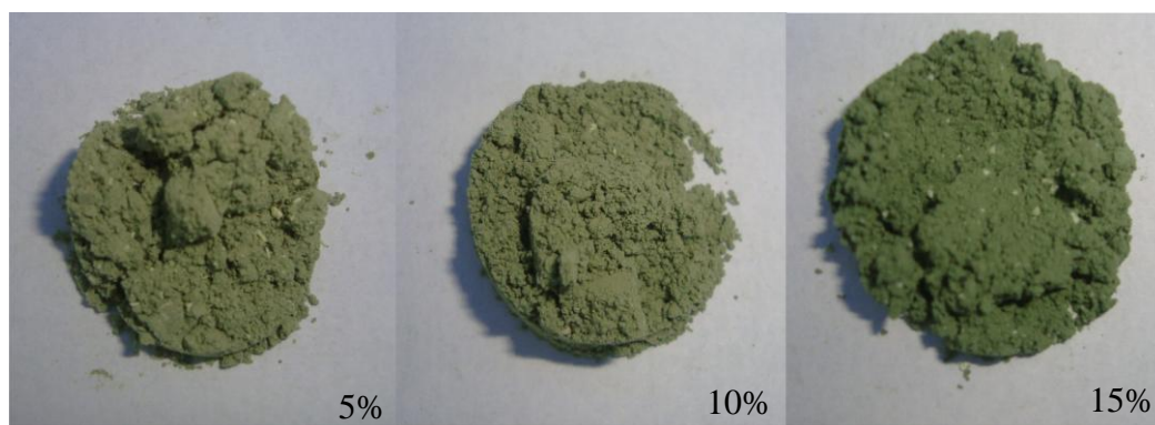
Figura 6 – Imagens da mistura de frita e óxido de cromo submetida a tratamento térmico a 950^\circ\text{C} por 30 minutos.
