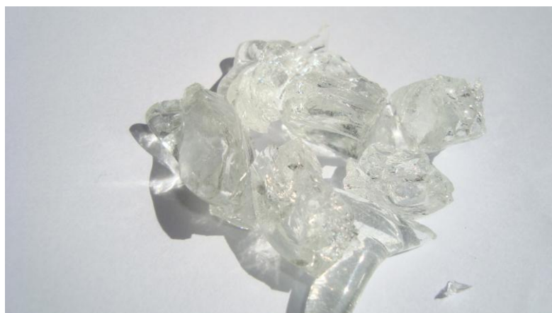
Figura 1 – Monolitos de vidro obtido pela fusão à 1550 °C e vertido em peça de grafite.
