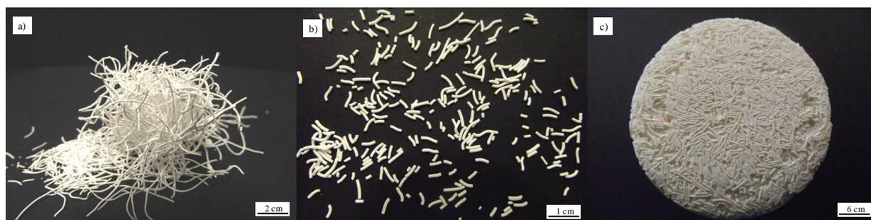
Figura 3: Fibras secas a) antes e b) após redução de tamanho; c) macroestrutura fibrosa após sinterização (1500°C) (amostras 050AC050HA).
