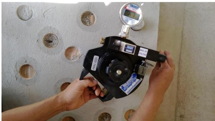
Figura 7 – Dinamômetro de tração para ensaio
