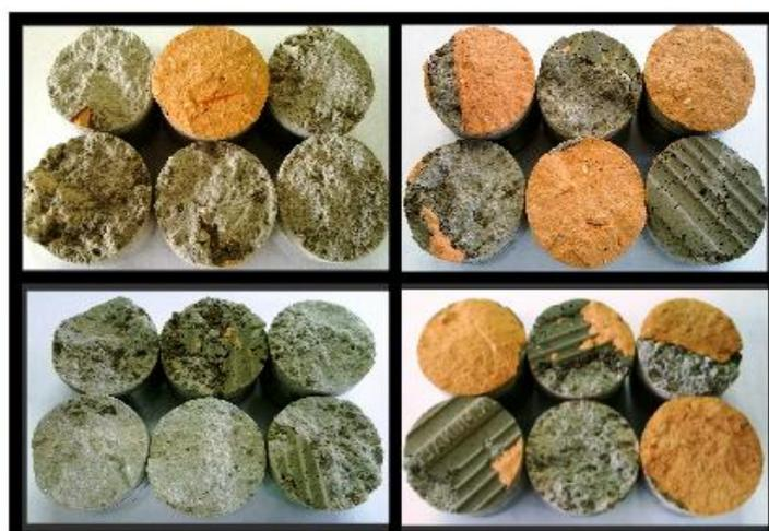
Figura 8 – Tipos de ruptura dos corpos-de-prova
