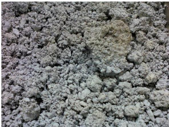
Figura 3: Resíduo seco após 24 horas na estufa em 110°C
