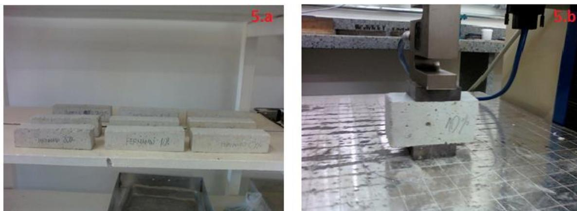
Figura 5.a: Corpo de prova em cura, Figura 5.b: Corpo de prova em ensaio de resistência a compressão.
