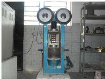
**Figura 06:** Bloco na prensa na posição Horizontal. Fonte: Própria, 2013.
