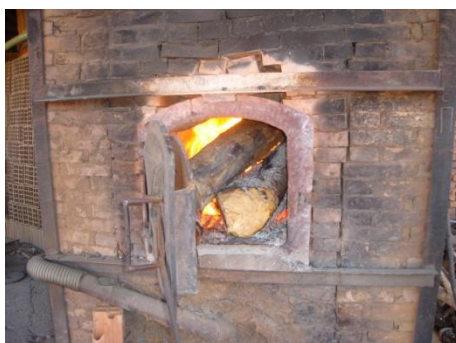
Figura 01. Fornalha de forno queimando lenha. Fonte: Oliveira, 2013.
