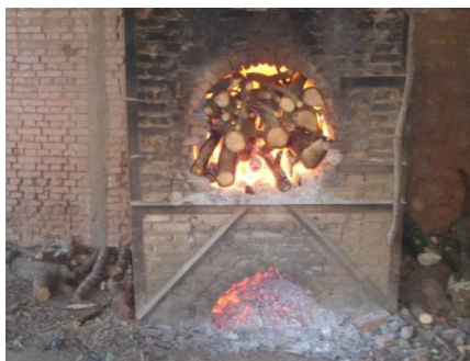
Figura 06. Fornalha cheia (lenha). Fonte: Curso de Processamento e Cerâmica Vermelha , Prof. Armando Oliveira, SENAI-SP, 2013.
