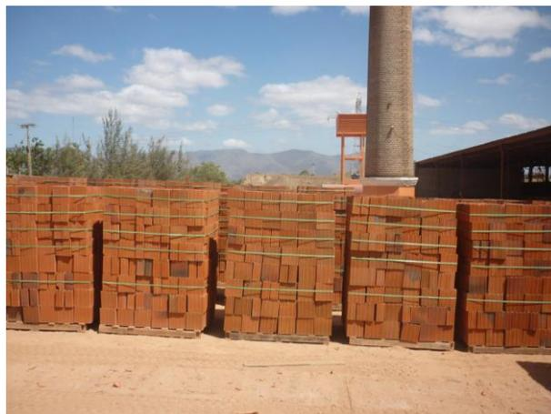
Figura 5: *Paletização* de blocos cerâmicos realizado por fábrica em Sobral/CE.
