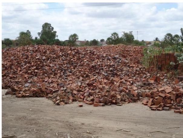
Figura 7: Resíduos de cerâmica vermelha de fábrica em Sobral/CE.
