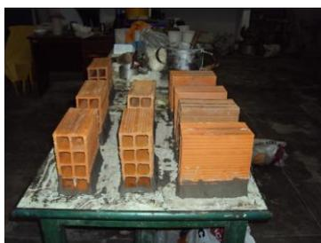
Figura 06– Capeamento dos corpos-de-prova em uma das faces.
