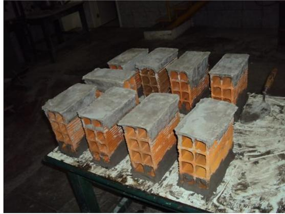
Figura 07 – Capeamento da face oposta dos corpos-de-prova.
