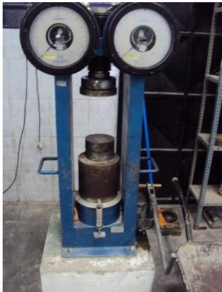
Figura 04 – Prensa usada para Romper os blocos.
