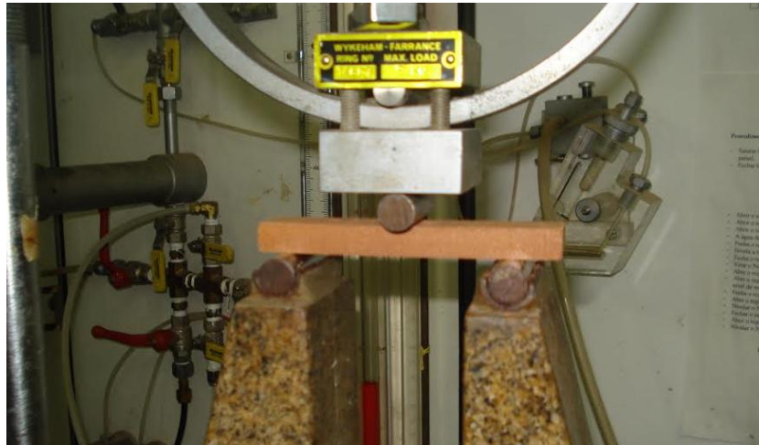
Figura 2 – Corpo de Prova sendo submetido à ruptura a flexão em três pontos.
