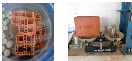
Figura 4 – Blocos em imersão e pesagem de um bloco para ensaio de absorção.
