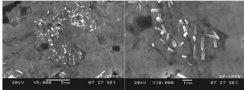
Figura 7- Micrografias do corpo sinterizado em 1300 °C.
