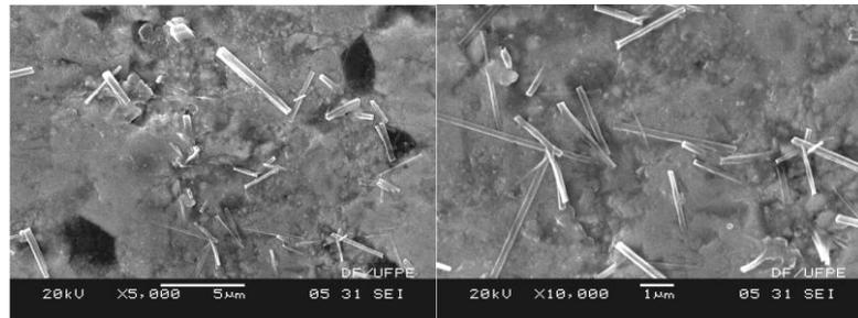
Figura 8 - Micrografias do corpo sinterizado em 1350 °C.
