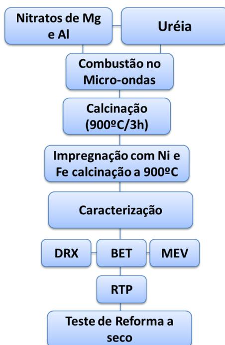
Figura 1. Fluxograma da preparação e caracterização dos catalisadores.
