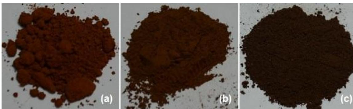
Figura 1 - Coloração das amostras de ZnFe<sub>2</sub>O<sub>4</sub> obtidas a partir dos combustores: (a) glicina, (b) anidrido Maleico e (c) ácido Cítrico.
