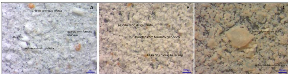
Figura 3: A) Micrografia da argila CAM 01 bruta, B) Micrografia da argila CAM 01 purificada fase 1, C) Micrografia da argila CAM 01 purificada fase 2.
