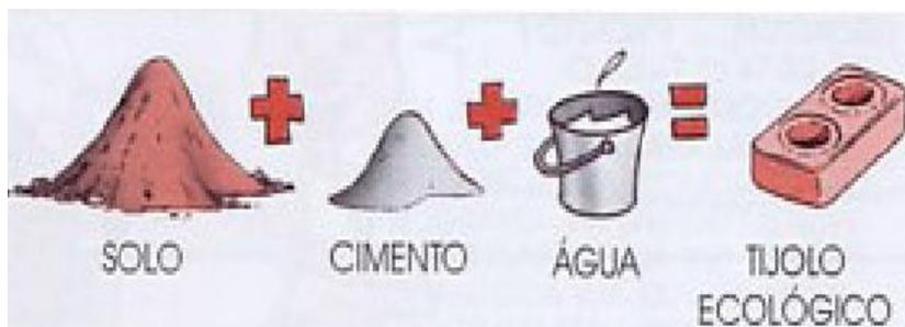
Fig. 1 – Composição do Tijolo ecológico de solo-cimento. Fonte: Mieli (2009)
