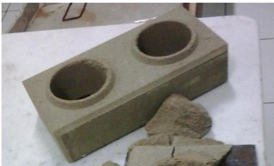
Fig. 2 –Tijolo ecológico de solo-cimento – Fábrica ECONSTRUIR.
