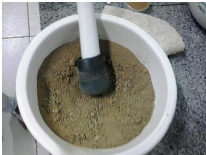
Fig. 3 – Solo destorroado para realização dos ensaios.
