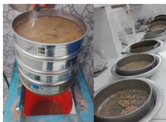
Figura 1. Peneiramento das amostras de pegmatitos, realizado á úmido.
