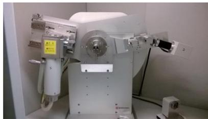
Figura 5: Difratômetro de raios-X XRD700 SHIMADZU. Foto: a autora.
