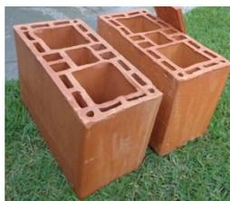
Figura 2- Forma geométrica do bloco estrutural cerâmico obtido através de extrusão. Foto: a autora.
