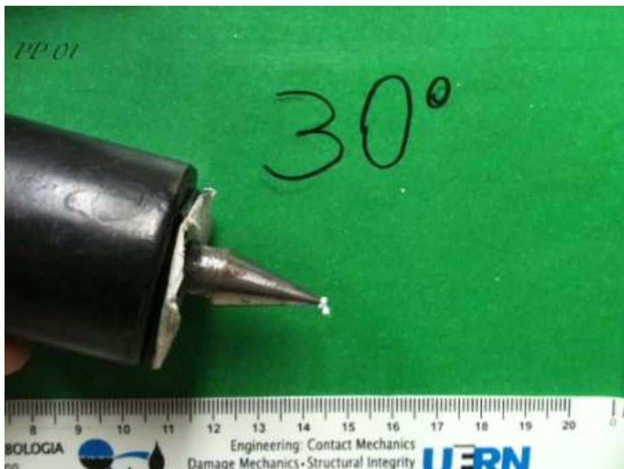
Figura 7: Material do C.P aderido ao indentador
