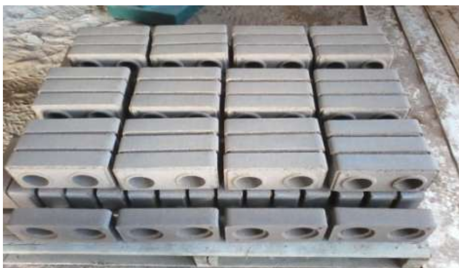
Figura 5. Amostras produzidas de tijolo solo-cimento.
