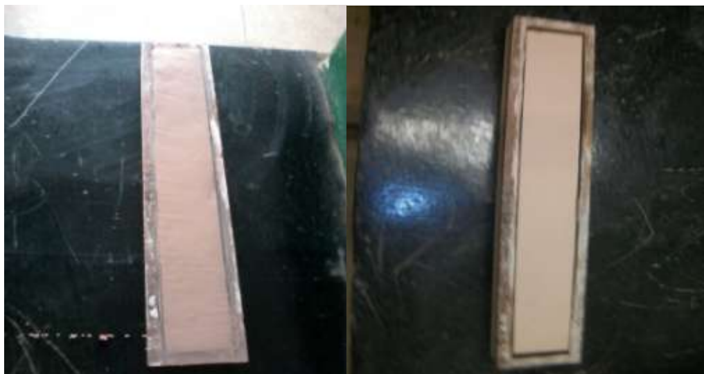
Figura 2. Início e fim do ensaio de Retração.
