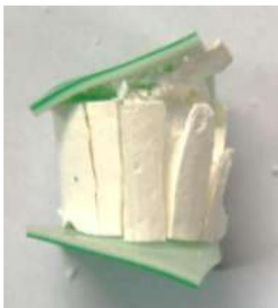
Figura 4 - Exemplo de ruptura no ensaio de compressão uniaxial – amostra "cilindro" (Alphabond) com 60% querosene.
