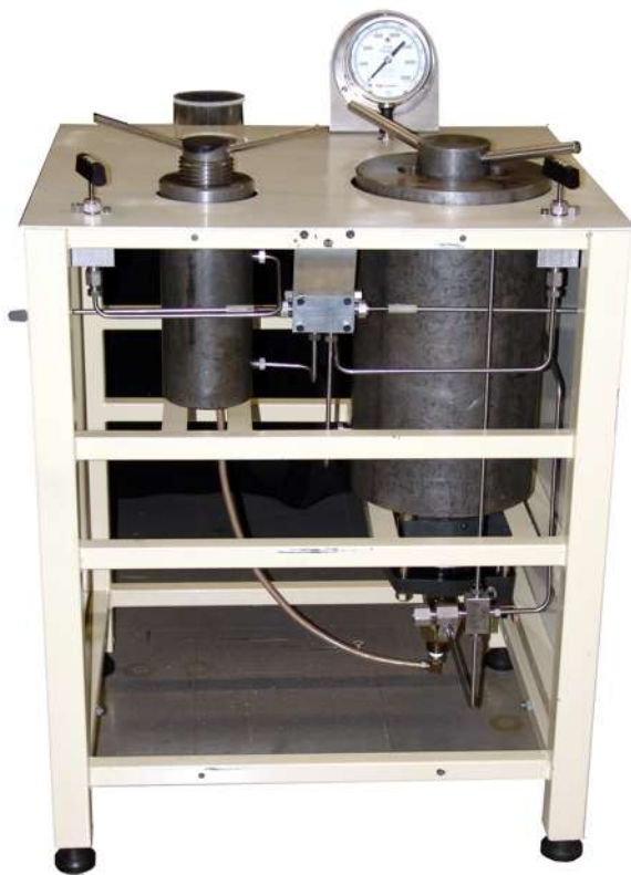
Figura 7- Prensa Isostática de vasos gêmeos construída, em a) imagem com vista interna e em b) imagem externa.
