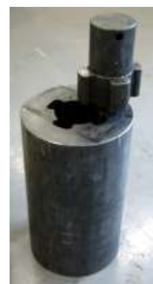
a) b) c) Figura 5- Vaso \varnothing i = 95,0 mm sistema de fechamento clover leaf em a) desenho de conjunto, em b) desenho da tampa e em c) vaso e tampa pós tratamento térmico.
