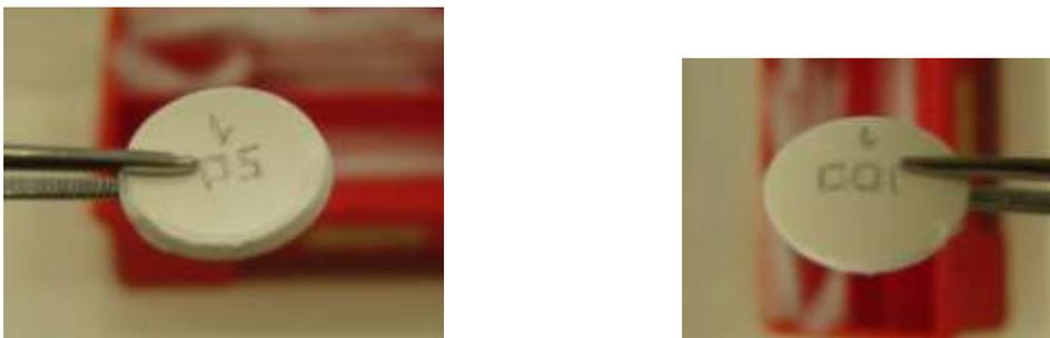
Figura 5. Imagens das amostras empenadas devido à retração diferencial das camadas.
