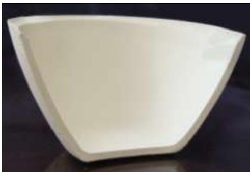
**Figura 5** – Peça resultante do processo de colagem
