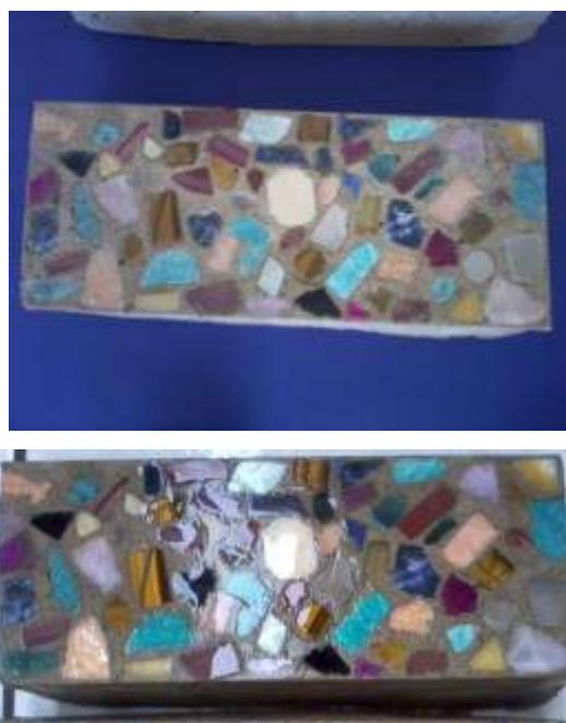
Figura 5 – Concreto após o polimento (2ª tentativa) seco e molhado
