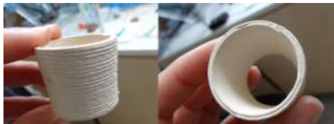
Figura 10 –Peça prototipada com massa pastosa por processo de extrusão. Fonte: Arquivo Pessoal referente a visita no Centre For Fibe Print Research – UWE.
