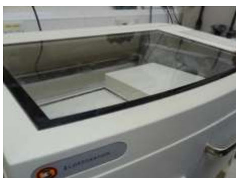
Figura 01. Equipamento de Prototipagem Rápida. Modelo: Z – 310 do Fabricante Z-Corporation. Fonte: Arquivo Pessoal referente a visita no Centre For Fibe Print Research – UWE.
