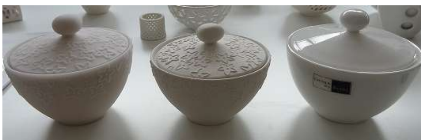
Figura 05 – Da esquerda para a direita: peça prototipada em ABS, peça prototipada em cerâmica, peça fabricada por processo cerâmico convencional. Fonte: Arquivo Pessoal referente a visita no Centre For Fibe Print Research – UWE.
