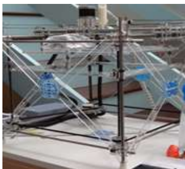
Figura 08 – Equipamento de Prototipagem Rápida Kit Rapman – Fabricante 3D Systems. Fonte: Arquivo Pessoal referente a visita no Centre For Fibe Print Research – UWE.
