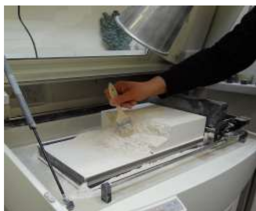
Figura 04. Processo de prototipagem: o suporte natural da peça é o próprio pó utilizado para confeccionar o protótipo. Fonte: Arquivo Pessoal referente a visita no Centre For Fine Print Research – UWE.
