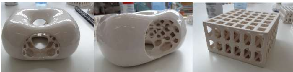
Figura 13 - Prototipagem rápida em cerâmica através de processo baseado em pó. Geometrias internas impossíveis de serem prototipadas por processo cerâmico convencional. Fonte: Arquivo Pessoal referente à visita no Centre For Fibe Print Research – UWE.
