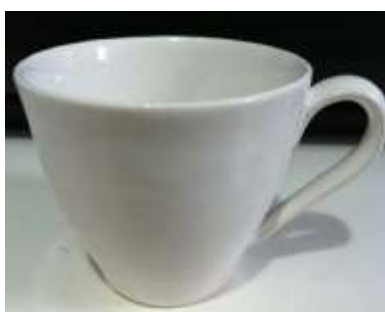
Figura 12 – Protótipo em cerâmica obtido por processo baseado em pó, Peça sem esmaltada. Fonte: Arquivo Pessoal referente a visita no Centre For Fibe Print Research – UWE.
