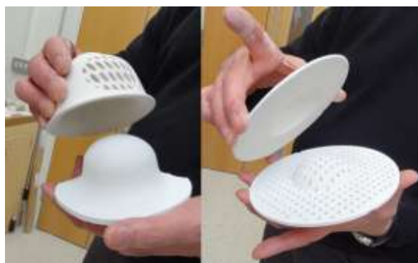
Figura 07. Suportes criados com a função de apoiar geometrias que tendem a desestruturar-se.. Fonte: Arquivo Pessoal referente a visita no Centre For Fibe Print Research – UWE.
