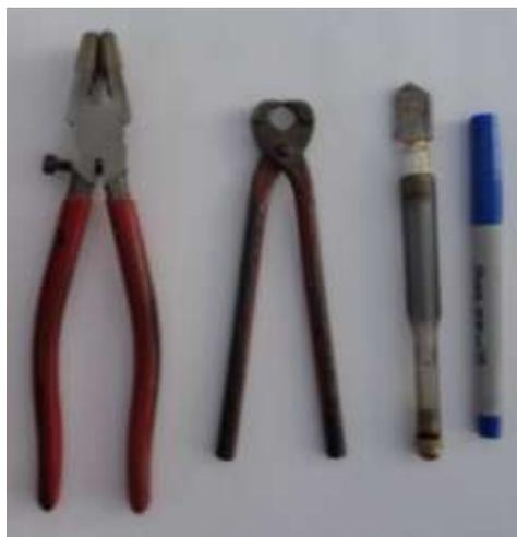
Figura 1: ferramentas para vidro – alicate bico de pato, alicate destacador, cortador, caneta marcador. Fonte: Autor.
