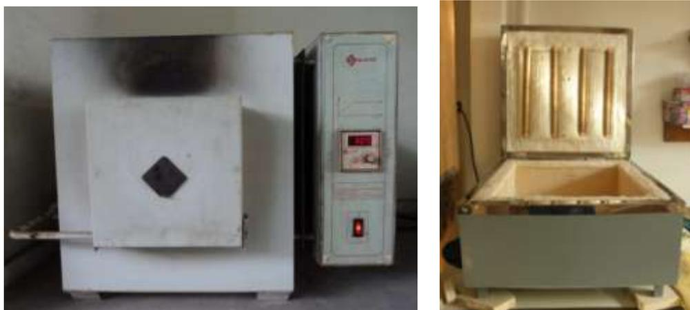
Figuras 6 e 7: mufla *Quimis* no Laboratório da UEPA; e forno para *fusing* vidro no *Atelier Azzurro* (SP). Fonte: Autor.
